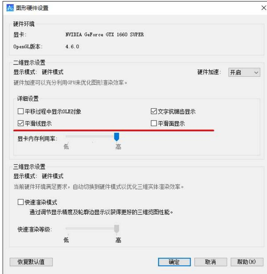
圖 14. 硬體加速面板中平滑線、平滑面的功能選項
